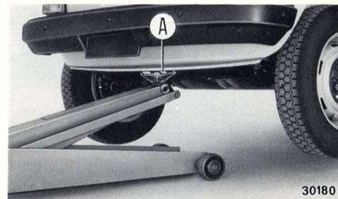
Per sollevare la vettura dalla parte posteriore disporre l'estremità del sollevatore sotto la staffa supporto B interponendo un tassello di legno dello spessore di alcuni centimetri.
