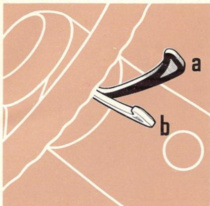
**Levetta comando tergicristallo:** sotto corrente quando la chiave del commutatore di accensione è nella posizione MAR. All'arresto i tergicristalli ritornano automaticamente in posizione di riposo.
