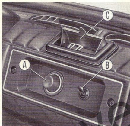
**Interruttore per illuminazione esterna e illuminazione quadro di controllo:** con l'interruttore **B** inserito e chiave del commutatore nelle posizioni MAR, P oppure ST, si accendono la lampada d'illuminazione del quadro di controllo, le luci targa e di posizione; si mette inoltre sotto corrente la levetta di commutazione proiettori.
